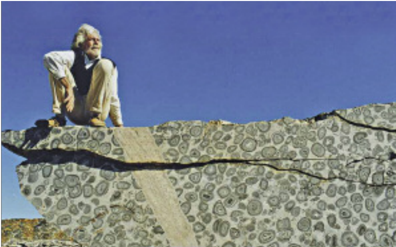
Bild 4: Der Orbicular Granit zerbrach in Australien bei der Kranverladung. Nur Bruchstücke konnten weiter verwendet werden.
