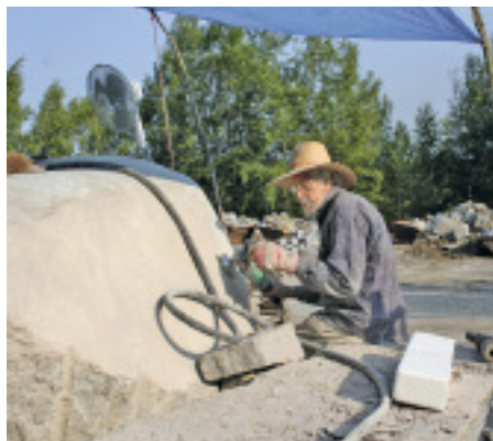
Bild 10: Der Granit wird trocken und nass mit Winkelschleifern geschliffen.
