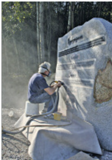
Bild 11: Schwarzenfeld bringt in den polierten Bereichen Schriftschablonen an, strahlt die Schrift auf den Stein und füllt die Buchstaben mit Schriftfarbe aus.
